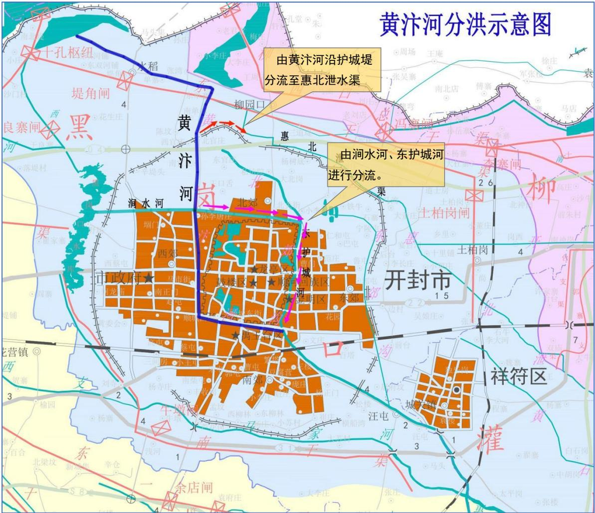
图3.3-1 黄汴河超标洪水分流示意图
